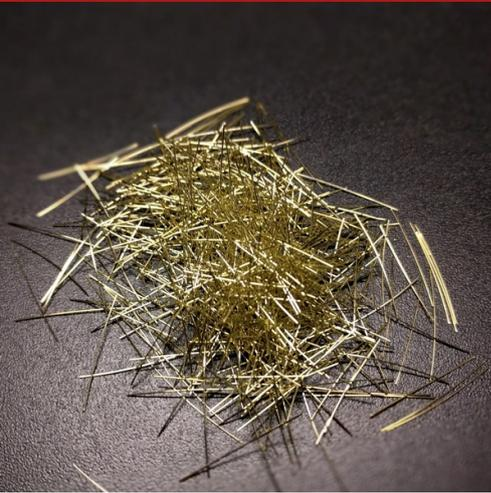
Mikrofasern aus vermessingtem Stahl, hergestellt durch das Schneiden von Metalldraht, für die strukturelle Verstärkung von Betonkonglomeraten im Allgemeinen. Readymesh MR besteht aus sehr dünnem vermessingtem Stahldraht mit einem Durchmesser von 0,22 mm und einer Länge von 6 o 20 mm, der hauptsächlich zur Bewehrung von Beton und Hochleistungsmörteln eingesetzt wird. Readymesh MR sind in zwei verschiedenen Längen erhältlich: Readymesh MR-060 = 6 mm; Readymesh MR-200 = 20 mm
