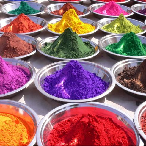
Protech Oxicrom ist eine chemische und anorganische Verbindung in Pulverform, hauptsächlich bestehend aus Eisenoxiden oder Eisenoxidhydraten. Mit Zugabe in geeigneter Menge und mit homogener Verteilung eignet sie sich in idealer Weise für die Pigmentierung von Zementkonglomeraten oder Ähnlichem, Verputzen und Farben. Protech Oxicrom Oxide sind in gelb, rot, braun, grün, blau und schwarz erhältlich.
