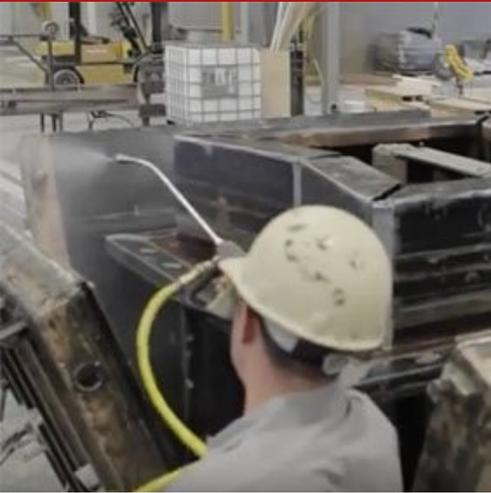
Trennmittel bestehend aus einer Mischung von ausgewählten organischer Verbindungen, Lösungsmittel und Korrosionsinhibitoren, gebrauchsfertig, speziell für Metallschalungen. Distak-M muss unverdünnt, direkt auf die zu behandelnden Oberflächen gesprüht werden.
