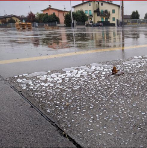
Wasser- und ölabweisendes, farbloses, nicht filmbildende Imprägnierung auf Basis einer Nanodispersion mit Siliciumverbindungen. Zum Schutz von Kalkputz, Zementmörtel, Beton, Naturstein, Backstein, Holz usw. vor Witterungseinflüssen, Frost-Tau-Wechsel und extremen Wetterbedingungen. Ohne Einfluss auf Oberflächenfarbe, ursprüngliches Aussehen und Atmungsaktivität.
