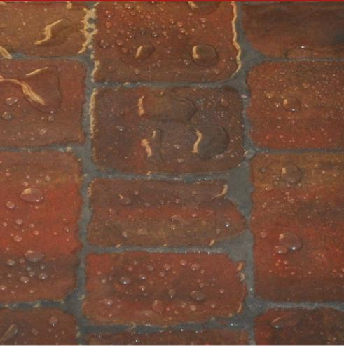
Consilex EM Drop ist eine wässrige, VOC-freie Emulsion Silanlösung zur Imprägnierung absorbierende Baustoffe mit Abperleffekt. Wasserabweisendes, farbloses, nichtfilmendes Imprägniermittel zum Schutz von Putz, Zementoberflächen, Naturstein, Tuffstein usw. Ohne chromatische Veränderungen der behandelten Oberflächen.
